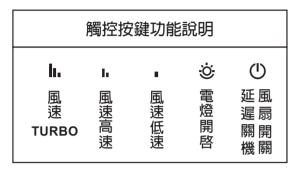
※風速TURBO鍵:按TURBO鍵時,馬達會以最高速運轉瞬間增強吸力,可應付大火 快炒所產生之瞬間大量油煙。
