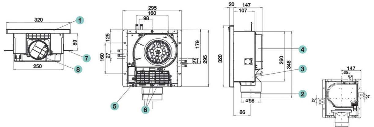
1 面板組合 Louver 2 出風口接頭 Adapter 3 機體 Unit Body 4 接線蓋板 Cordcover plate 5 加熱器組合 Heater assembly 6 出風柵格 Air outlet grille 7 懸掛托架 Suspension bracket 8 檔片 Shutter
